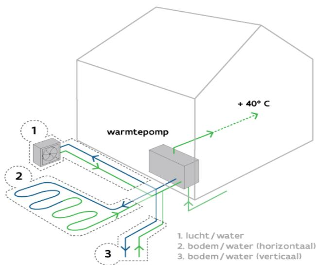
Als uw woning al goed geïsoleerd is en als u beschikt over oppervlakteverwarming of voldoende grote radiatoren, dan kunt u de plaatsing van een warmtepomp overwegen. Bij uw renovatie kunt u het best kiezen voor een systeem met een seizoensprestatielijstfactor (SPF) van 4 of hoger.
