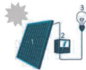
1. Zonnepaneel | 2. Omvormer 3. Elektrische toestellen
